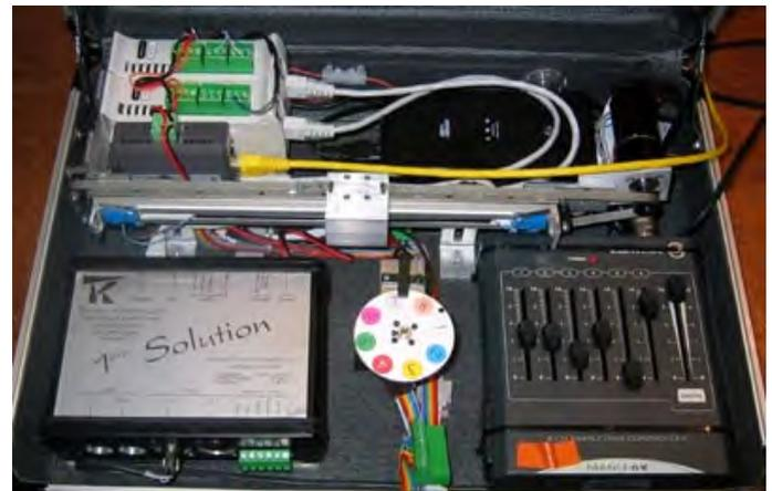
La valise de démo de Thierry Kaltenrieder. En bas à droite : un petit pupitre DMX 6 canaux. En bas au centre : un moteur en rotation avec, par exemple, un disque de couleurs à 8 positions. En bas à gauche : l'interface. En haut à gauche : les deux cartes de moteurs. En haut au centre : l'alimentation des moteurs. Au milieu : l'axe de démo de la translation.
