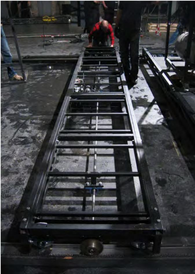
*Stifters Dinge*, détail d'un pont roulant, la motorisation est au milieu
