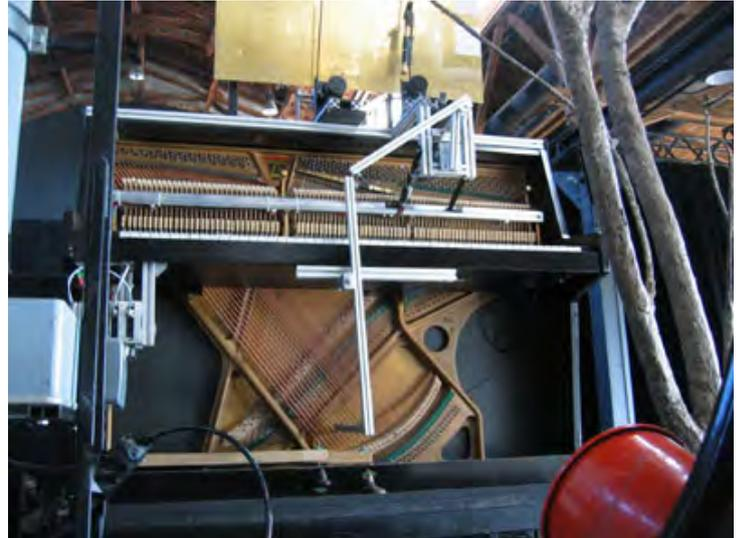
*Stifters Dinge*, vue d'un piano mécanisé et du système d'entraînement de son archer
