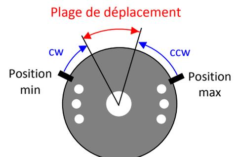
**Un seul circuit avec 255 positions vous permet de contrôler le mouvement avec précision.**
